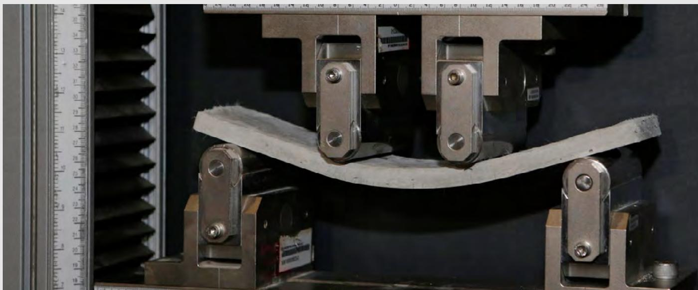
El nuevo material se ha diseñado empleando microfibras poliméricas. Estas fibras sintéticas no solo hacen que el hormigón sea más flexible, sino que también adquiere más resistencia al deslizamiento.
